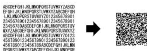
ภาพที่ 1: การบรรจุข้อมูลของ Alphanumeric จำนวน 300 ตัว ไว้ใน QR CODE เพียง 1 ภาพ
