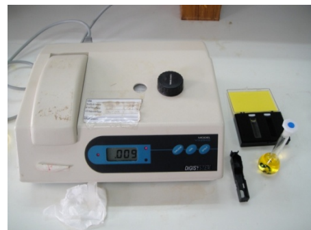
ภาพที่ 4: เครื่อง UV-spectrophotometer
